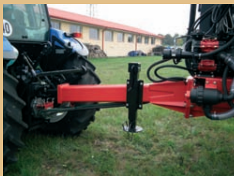
Sztynny zaczep górny oraz przekazanie mocy za pomocą układu hydraulicznego
