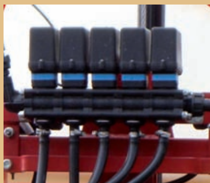
Elektrozawory 5, 7 lub 9 sekcji, sterujące cieżką, stosowane z jednym ze sterowników
