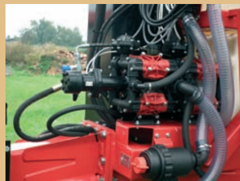
Zestaw dwóch pomp, oddzielna do układu mieszania 160 lub 180l/min. 20 bar i układu opryskowego 160, 180 lub 200 l/min. 20 bar
