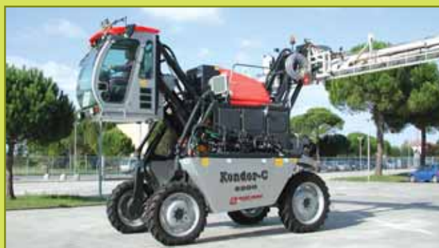
KONDOR C - przeznaczony do oprysku roślin wysokich np. kukurydzy.
