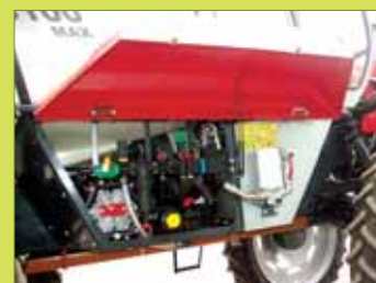
Wygodny dostęp do filtrów, pompy oraz zaworów sterujących.
