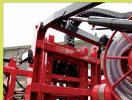
Pneumatyczna amortyzacja belki oraz wąż ze smokiem do napełnienia zbiornika hydraulicznie zwijany (opcja).
