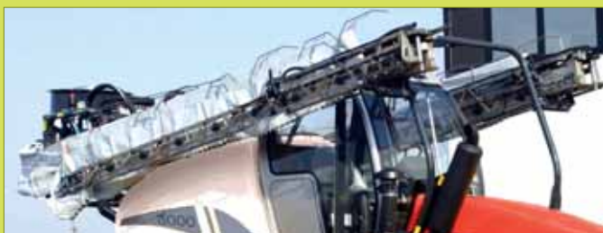
System rękawa powietrznego zwiększa skuteczność zabiegów oraz uniezależnia od warunków atmosferycznych.
