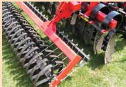
Wał pierścieniowy ze zgrzebłem, doskonały na gleby ciężkie, bardzo zwięzłe jak i zakamienione.
