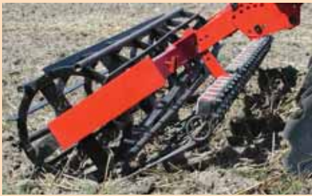
Wał strunowo-rurowy ze zgrzebłem, dobry na gleby lekkie i średniozwięzłe.
