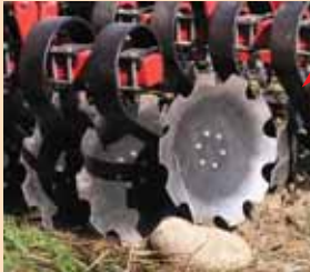
Indywidualne sprężyny zabezpieczają talerze przed uszkodzeniem oraz powodują lepsze zagłębienie się talerzy.
