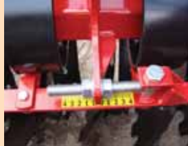
Regulacja kąta natarcia talerzy od 0 do 25^\circ . W wersji bez regulacji kąt natarcia stały 18^\circ .
