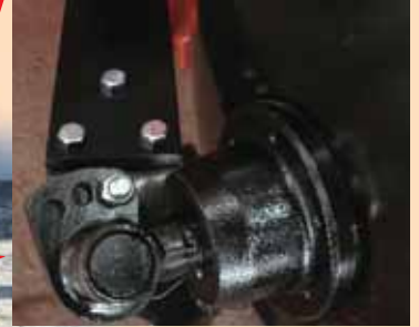
Regulacja kąta pochylenia talerzy \pm 12,5^\circ .
