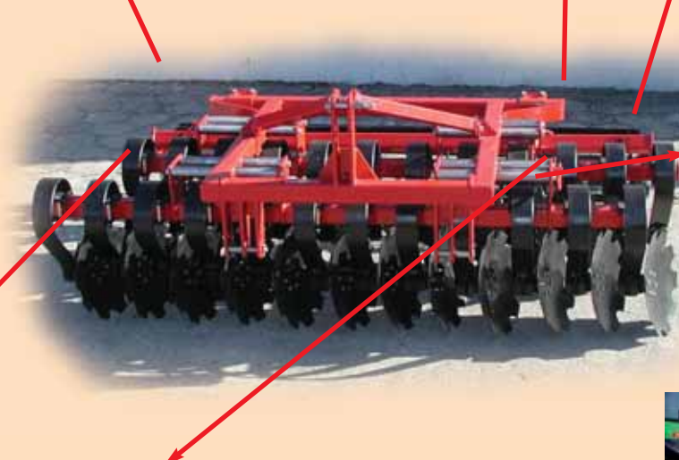
Regulacja kąta pochylenia talerzy \pm 12,5^\circ .
